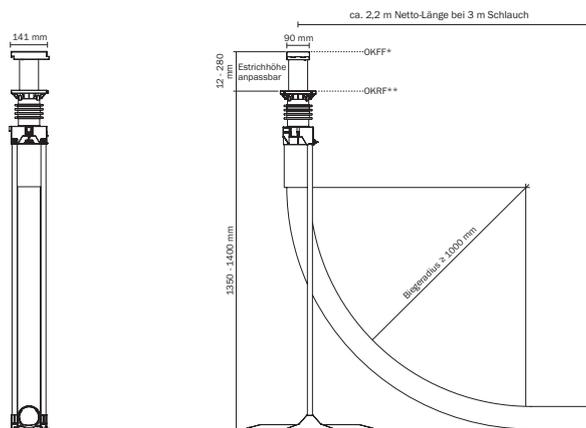
\*OKFF = Oberkante Fertigfußboden, \*\*OKRF = Oberkante Rohfußboden
